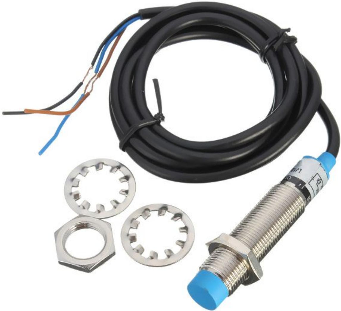
感应式接近开关在接触铁质金属和不含铁的金属时的工作原理有所不同。感应式接近开关通过其内部振荡电路在其前表面产生一个高频磁场。当有铁质金属接近它时，铁质金属很容易被磁化，磁化的过程会吸收高频磁场的能量。
