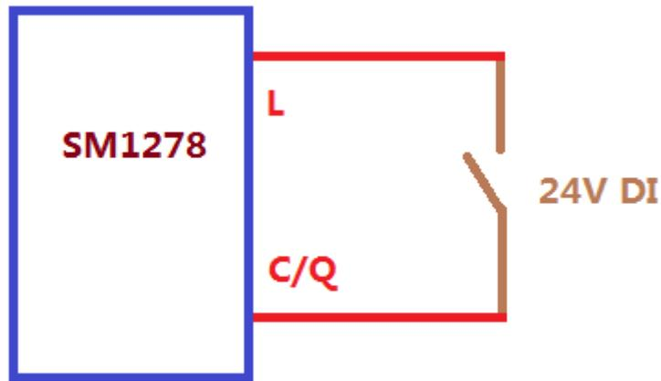
在数字量输出（DQ）模式下，SM1278连接数字量继电器的接线原理图如下：
