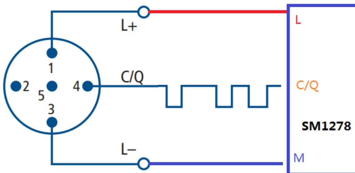
在数字量输入（DI）模式下，SM1278连接数字量开关的接线原理图如下：
