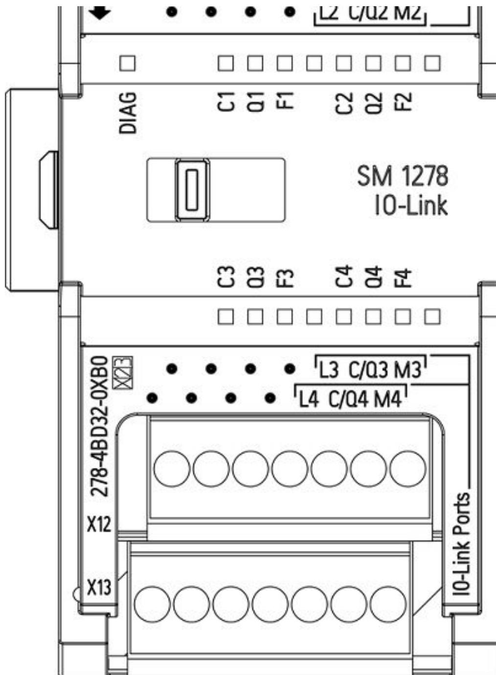
每个端子排有7个接线端子，各端子的定义如下：
