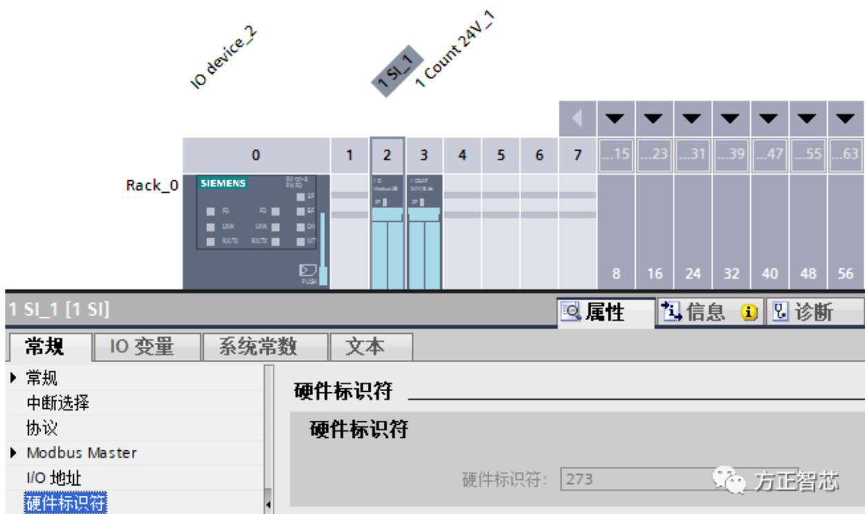
使用指令S\_RCV进行接收数据，其地址参数LADDR就应填写1 SI模块的硬件标识符：273，如下图：
