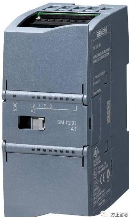
SM 1231 AI 4x13 bit 消耗背板5V电流 80mA，消耗24V传感器电流45mA； SM 1231 AI 8x13 bit 消耗背板5V电流90mA，消耗24V传感器电流45mA； SM 1231 AI 4x15 bit 消耗背板5V电流80mA，消耗24V传感器电流65mA（每一种模块我们都会介绍下其电流消耗，因为这涉及到硬件安装后能否正常工作，更多关于S7 1200电流消耗的计算，请看文章：S7-1200硬件篇之如何选择电源模块）；
