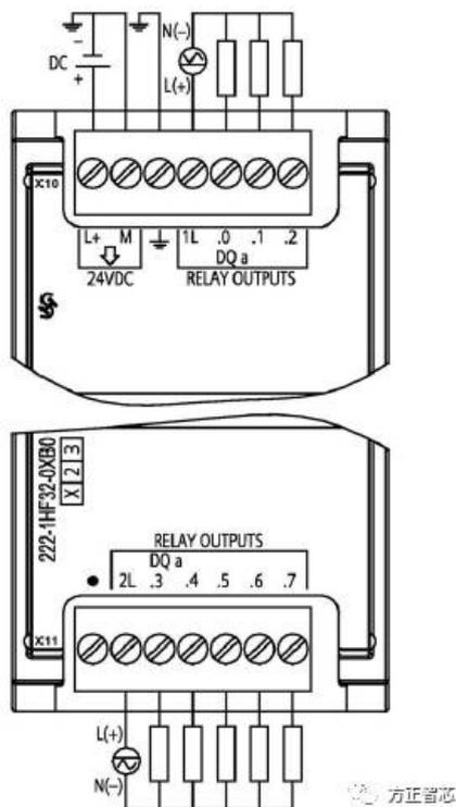
SM 1222 DQ 16XRelay模块消耗背板5V电流135mA，每使用一个输出通道消耗24V传感器电流11mA，外观如下图：
